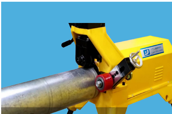
3. (주)영광밴드 그루빙 전용공구로 작업 후 치수표 (page 28)를 참조하여 치수값을 정확히 내야 합니다. (측정자로 치수측정)
